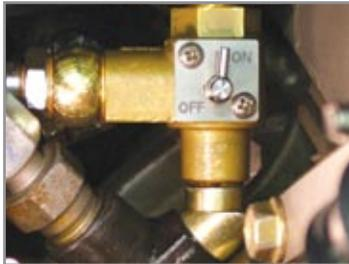
Figure 6.4.1– Manual Bypass Lever
