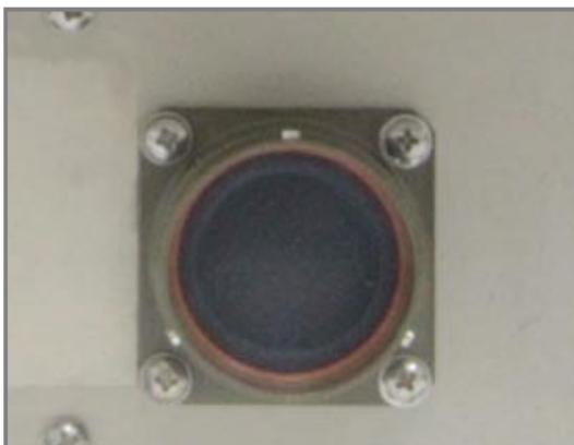
Figure 2.12.2 -Dummy Plug Receptacle
